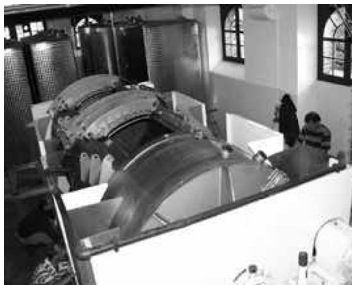
... là, un appareil de la dernière génération, équipé d'une membrane pneumatique capable de fournir un moût d'une qualité équivalente à celle obtenue dans un pressoir traditionnel.
